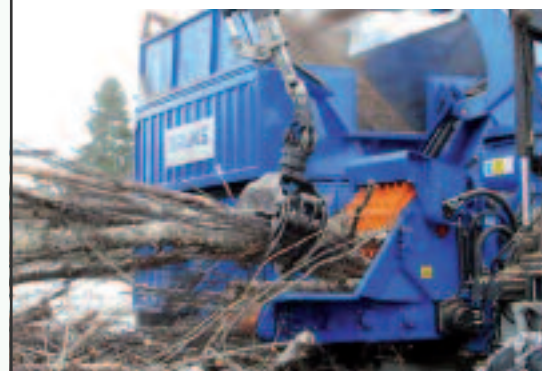
Bruks 806STC Für Aufbau, z. B. auf Forwarder, mit eigenem Dieselmotor und hochkippendem Hackschnitzel- behälter
