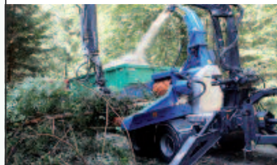
Bruks 605PT Trailer Kompakt und flexibel, Trommeldurchmesser 600 mm
