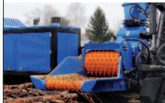
Bruks 1006 Der neue Starkholz-Mobilhacker, Volvo Dieselmotor mit 565 kW (768 PS) 750 mm Einzugsgröße
